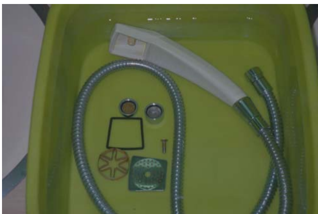
図2-2 シャワーヘッドの分解・清掃の例
