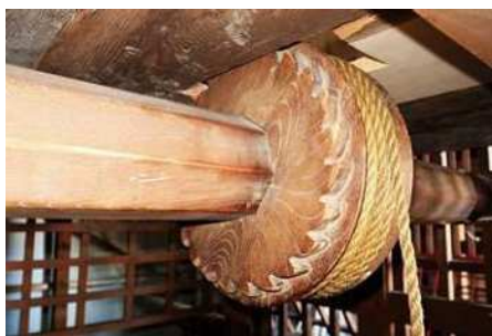
写真 4-8 若戎車 鯢巻き 綱巻輪と止め歯車
