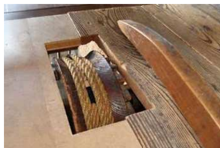
写真 4-9 若戎車 鯢巻き 止め爪
