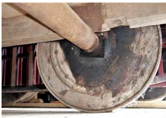
7 若戎車 下山車輪軸受け
