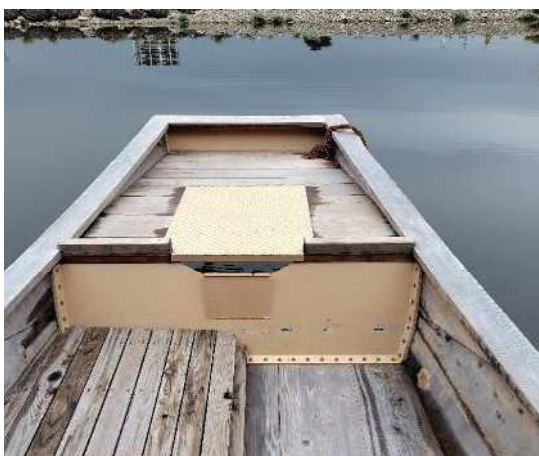
船後方 船外機脱着箇所
