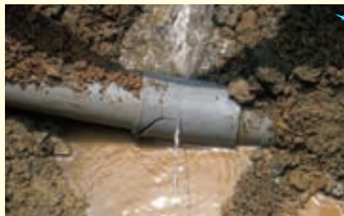
管の接続部分（継手）からの漏水
