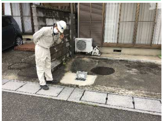
音聴棒による戸別音聴調査
