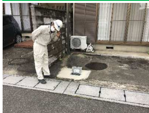
音聴棒による戸別音聴調査
