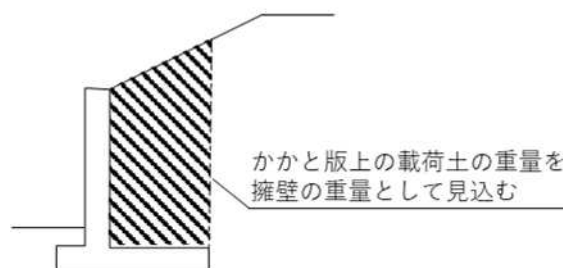
図 2-10 擁壁の自重の考え方(例)
