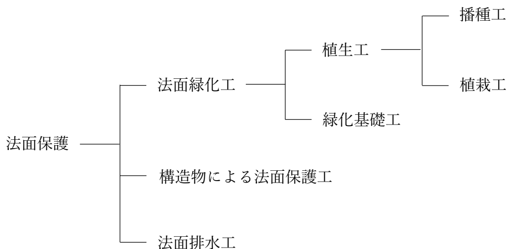
図 4-1 法面保護工の分類
