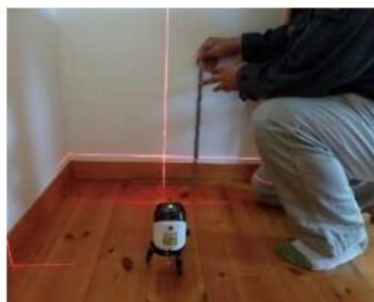
「床の傾きを計測する」調査機器
