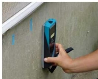
「基礎配筋」の調査機器
