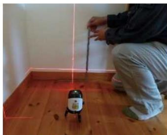
「床の傾きを計測する」調査機器
