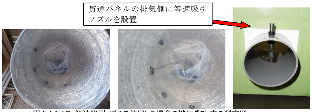
図4.14.17 等速吸引ノズルを使用した場合の排気ダクト内の測定例
