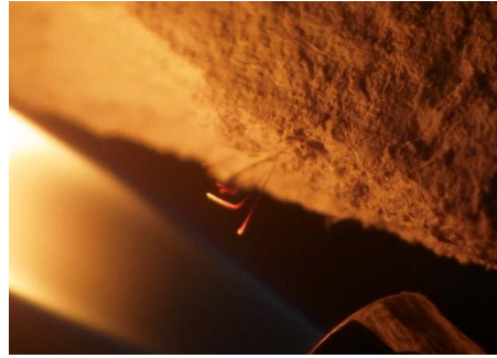
(参考資料) 写真 3-2 燃焼試験 注) 有機繊維を減らして、無機繊維を見やすくする
