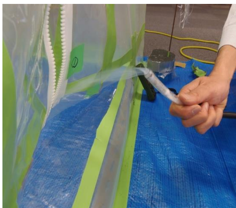
図 4.14.10 スモークテスターによる確認
