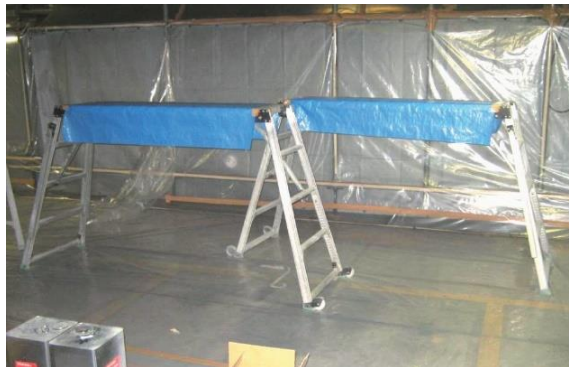
図 4.7.57 可搬式作業台の例
