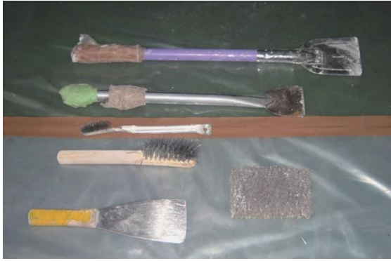
図 4.7.58 除去作業用の手工具の例
