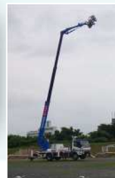
照明車(国と連携した 水防活動支援に使用) ※木曽川上流河川事務所より
