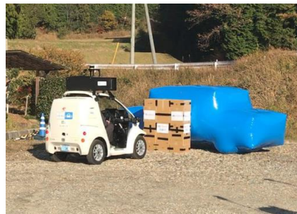
障害物検知と衝突回避実験
