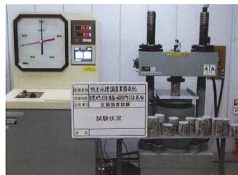
圧縮強度試験実施状況
