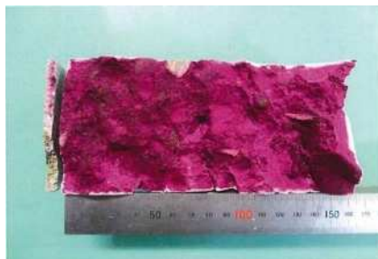
コンクリートコアによる中性化深さ測定状況
