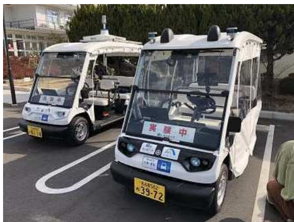
ゆっくりカート (誘導線方式でない日本初の自動運転ランドカー)
