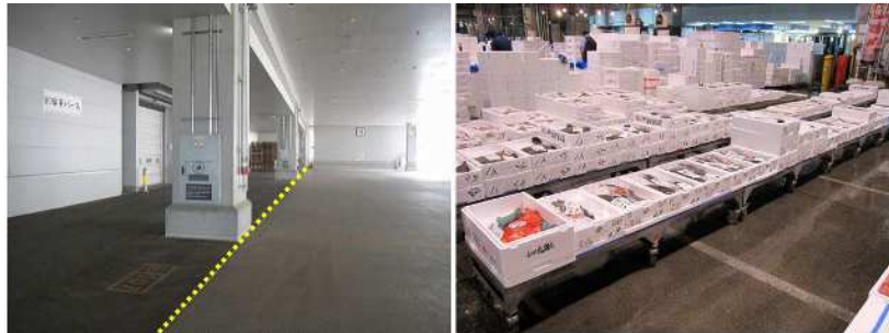
図表 26 衛生管理対応例 (棟内・棟外エリアの明確化) (商品陳列時の高さ確保)
