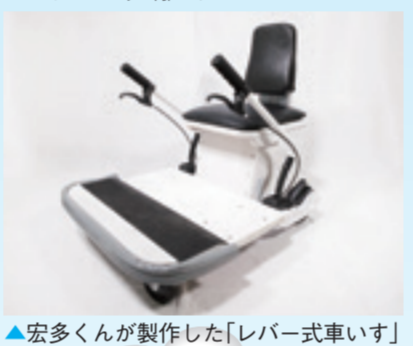
▲宏多くんが製作した「レバー式車いす」
