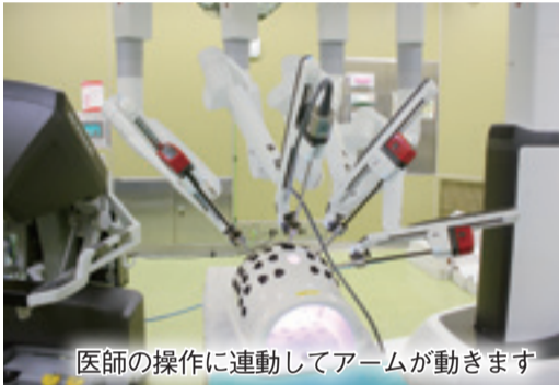
3D映像を見ながら、アームを遠隔操作します
