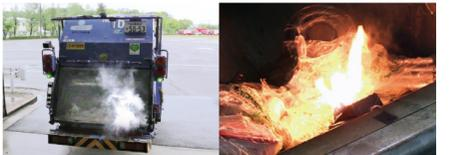
▲収集車でのモバイルバッテリー火災を再現した様子
