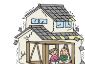
耐震シェルター
