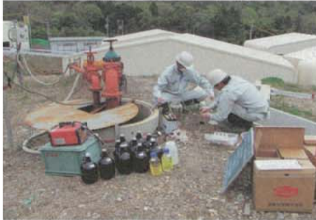
〈止水壁揚水採水〉
