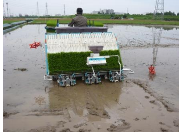
田植え機 なえ の後ろの台に苗を積み、田植えが始まる様子
