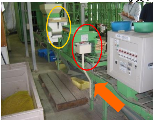
緑色の機械が播種機です。 ・土がまかれた育苗箱が矢印の方向に流れていきます。 ・赤丸のところで種もみが育苗箱にまかれます。 ・黄丸のところで種もみの上に土がまかれます。
