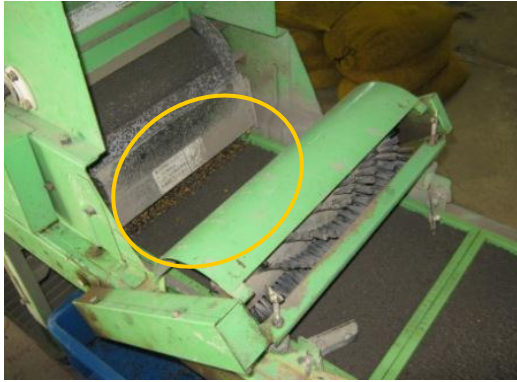
写真1の黄丸部分で種もみの上に土がまかれる様子
