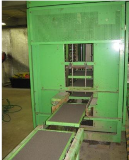
土のまかれた育苗箱は写真奥の緑色の機械の中で積み重ねられ 出芽室の中に運ばれます。
