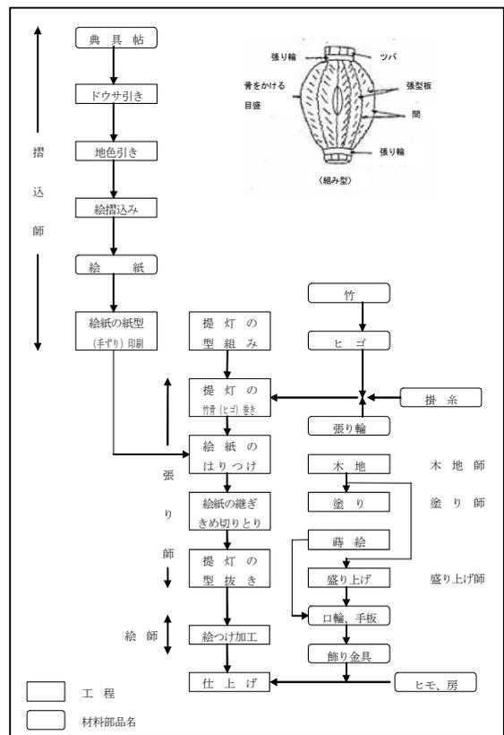
図Ⅱ-3-3 岐阜提灯の製作工程
