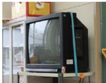
写真2. ベルトによる固定の例
