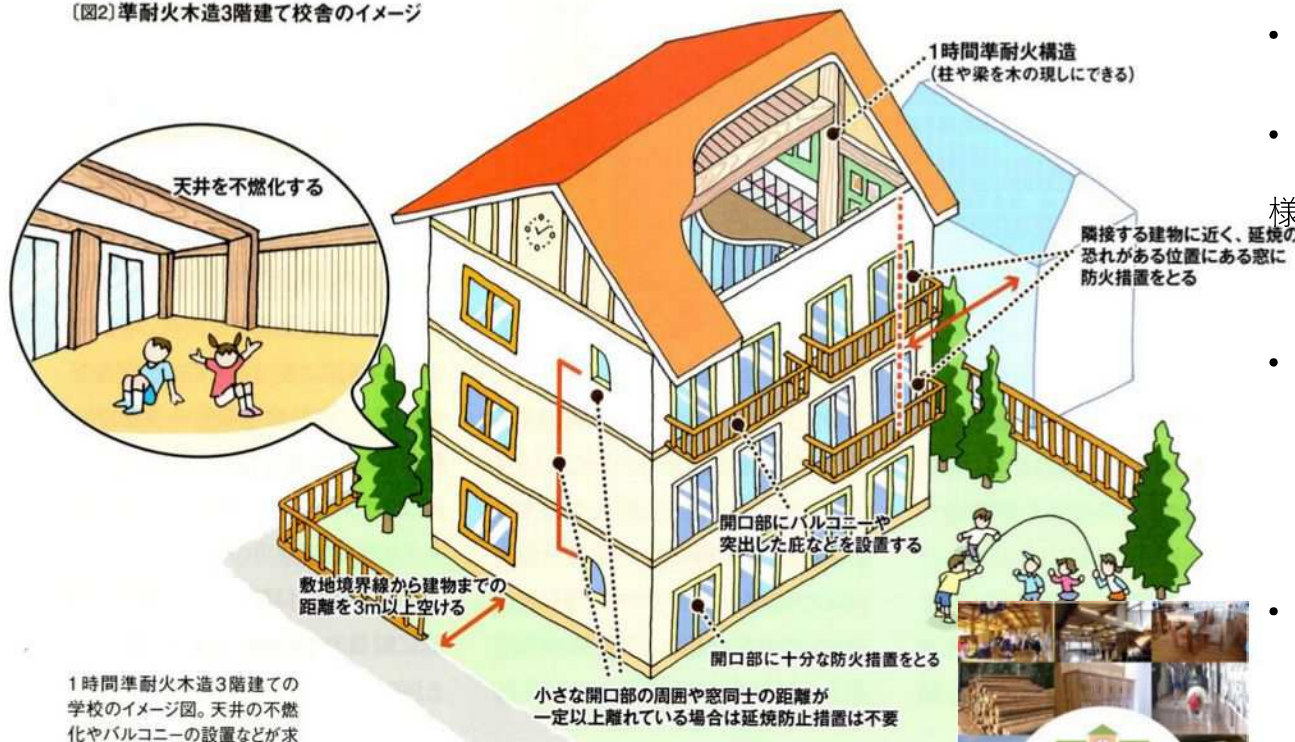
〔図2〕準耐火木造3階建て校舎のイメージ
