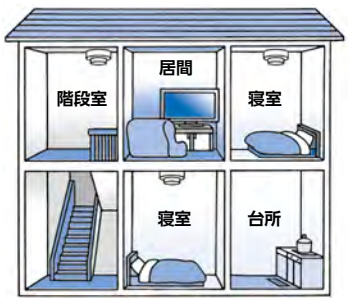
▲住宅用火災警報器の設置場所
