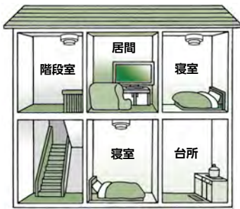
▲住宅用火災警報器の設置場所
