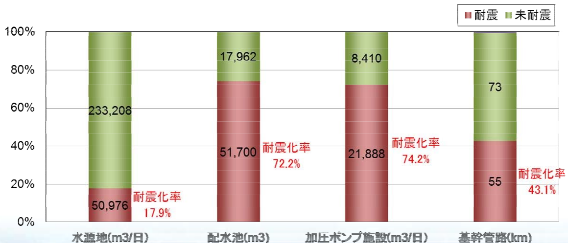
図 3-4-2 水道施設の耐震化率(平成27年3月現在)
