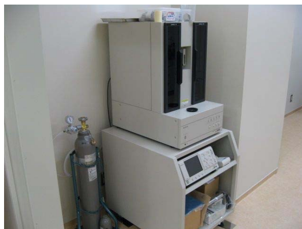
低バックグラウンド放射線測定器 (全 \alpha 線、全 \beta 線の測定)
