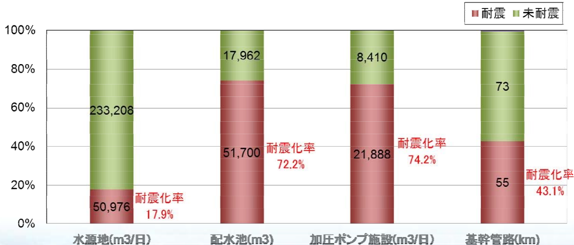
図 3-4-2 水道施設の耐震化率(平成27年3月現在)
