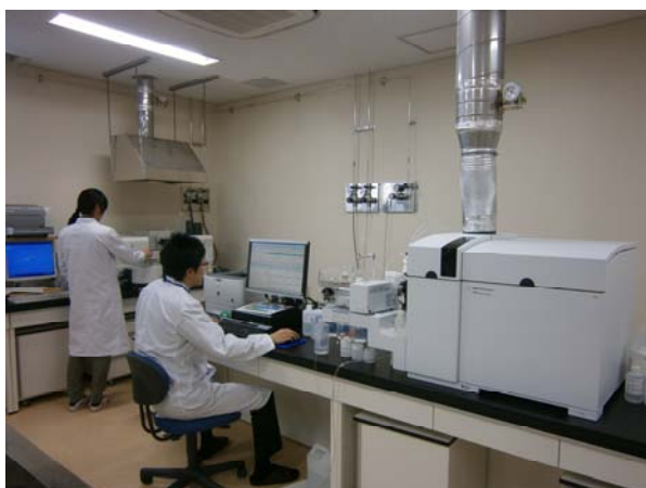
高周波誘導結合プラズマ質量分析計 (重金属類の測定)
