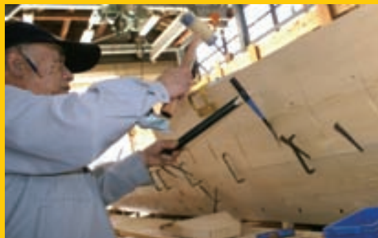
▲クギを打ち込むための先穴を、モジを使って広げていきます。
