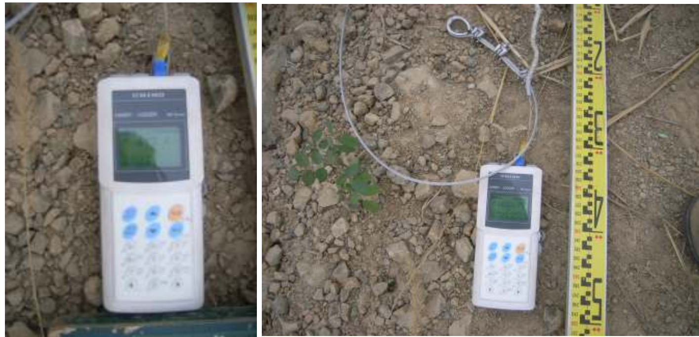
写真 3-2-1 b-31 孔底部の温度測定状況
