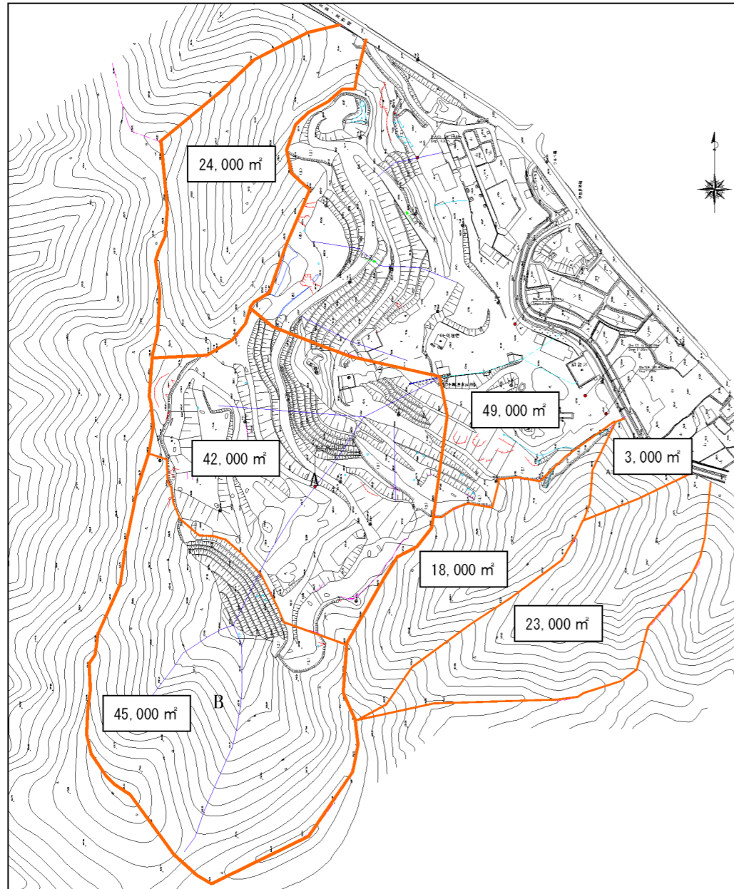
図 3.8 不法投棄現場周辺の流域図「産業廃棄物不法投棄現場汚染状況調査業務報告書に加筆」
