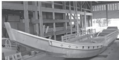
船体内部を固定した後、手摺り・屋形を製作する。
