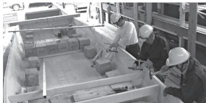
平らな板に石の重しを乗せてしならせ、反り上げていく。船体内部が完成するまでは、重しは乗せたまま。船底には樹脂を塗る。
